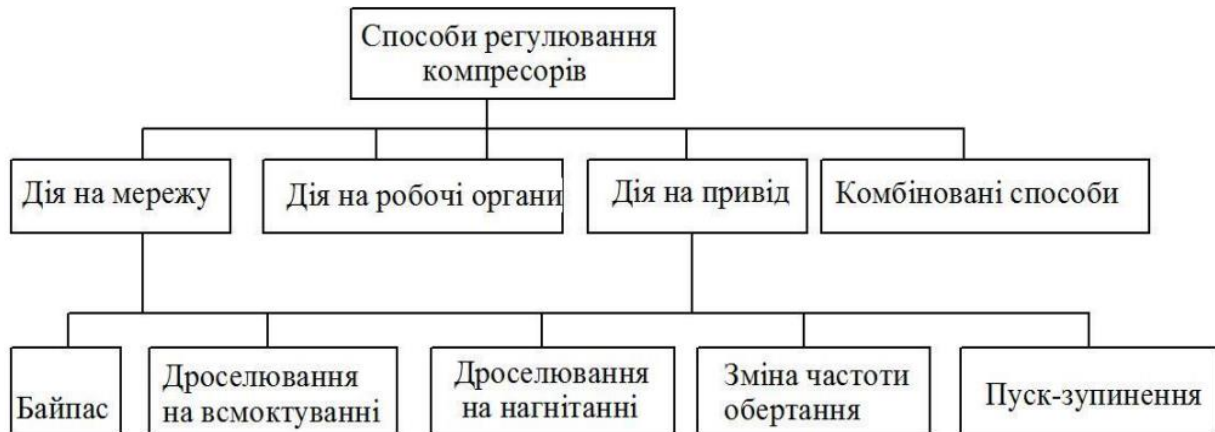
Рисунок 2 – Класифікація способів регулювання компресорів
