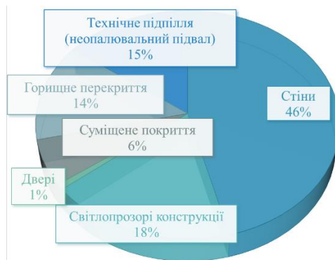
Рисунок 1 – Теплові втрати через існуючі ОК досліджуваної будівлі
