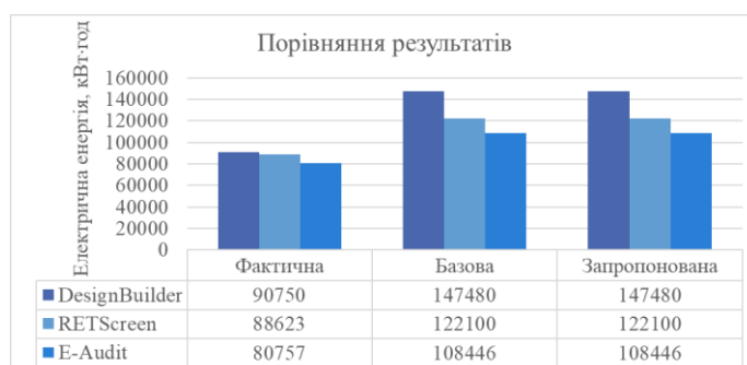
Рисунок 3 – Порівняння результатів моделювання в трьох обраних програмних забезпеченнях (споживання електричної енергії)
