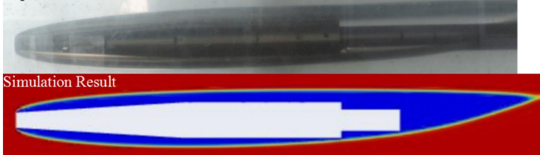
Рисунок 3 – Суперкавітуючий снаряд у повітряній порожнині
