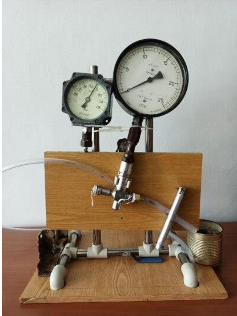
Рисунок 2 – Зовнішній вигляд кавітаційного пристрою із встановленими вимірювальними приладами
