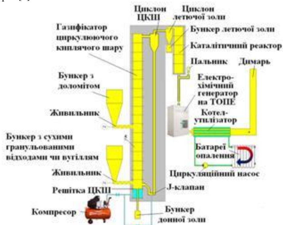
Рисунок 1 – Схема процесу газифікації твердих відходів для отримання синтез-газу та виробництва електроенергії [2]
