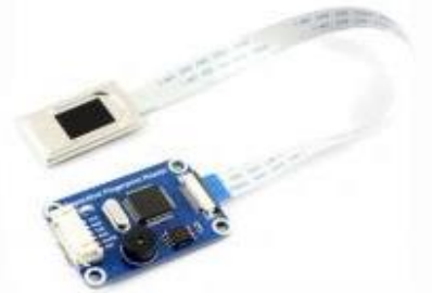
Рисунок 1 – Модуль ємнісного сканера відбитків пальців
