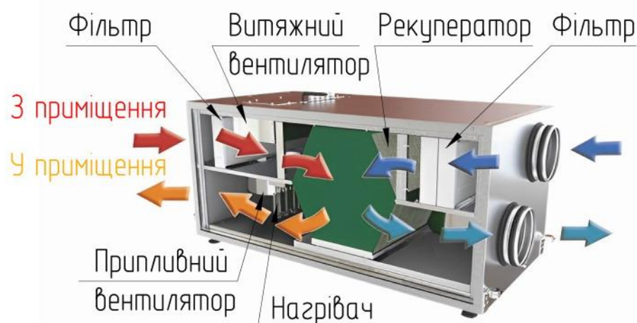
Рисунок 2 – Типова схема вентиляції з рекуперацією тепла [5]
