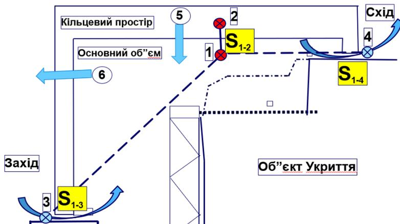
Рисунок 1 – Схема НБК в поздовжньому перерізі. На рисунку: 1 – основний об'єм; 2 – кільцевий простір; 3 – західна протічка; 4 – східна протічка; 5 – нагнітання в кільцевий простір та основний об'єм; 6 – витяжка з основного об'єму
