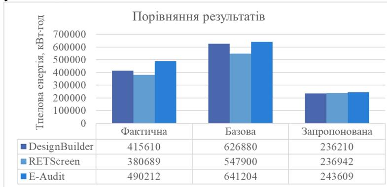
Рисунок 2 – Порівняння результатів моделювання в трьох обраних програмних забезпеченнях (споживання теплової енергії)
