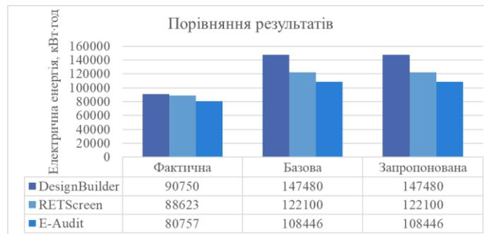
Рисунок 3 – Порівняння результатів моделювання в трьох обраних програмних забезпеченнях (споживання електричної енергії)
