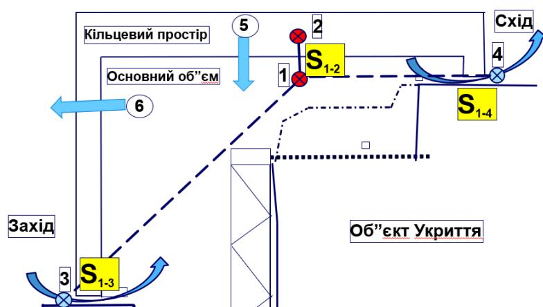
Рисунок 1 – Схема НБК в повздовжньому перерізі. На рисунку: 1 – основний об'єм; 2 – кільцевий простір; 3 – західна протічка; 4 – східна протічка; 5 – нагнітання в кільцевий простір та основний об'єм; 6 – витяжка з основного об'єму
