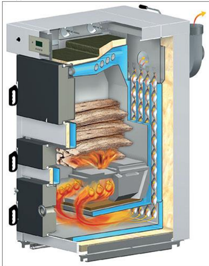
Рисунок 2 – Схема піролізного котла для ефективного спалювання біомаси з утворенням синтез-газу [3]
