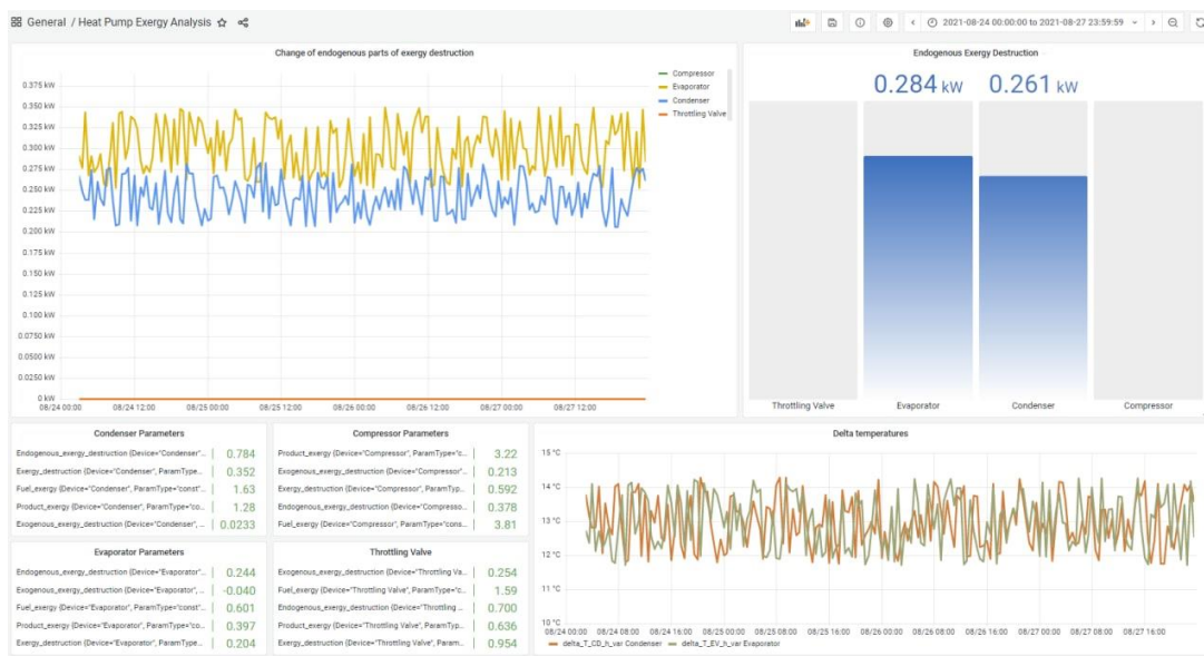
Рисунок 2 - Приклад приладової панелі для діагностування несправності теплового насоса на основі поглибленого ексергетичного аналізу
