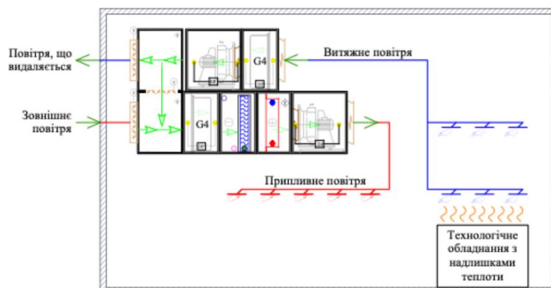
Рисунок 2 – Припливна установка з дворівневою камерою змішування
