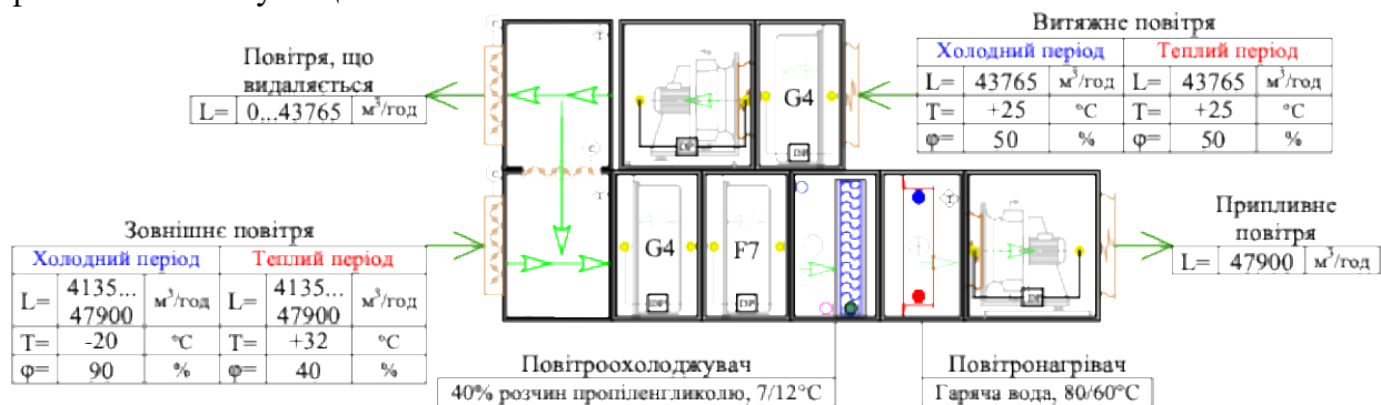
Рисунок 1 – Вентиляційна установка, що є об'єктом дослідження
