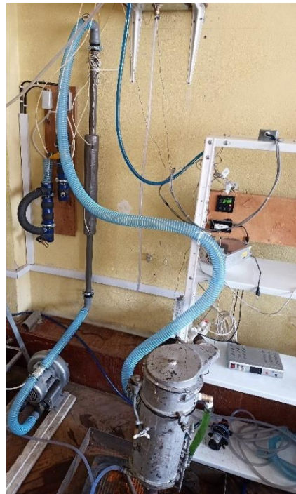
Рисунок 1 – Контактна камера зволоження повітря ерліфтного типу: а – принципова схема; б – зовнішній вигляд на експериментальному стенді
