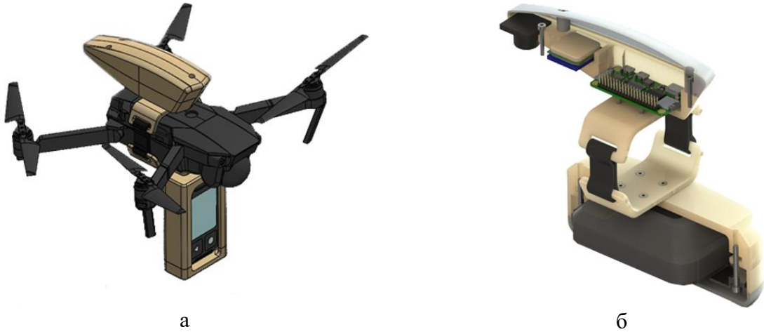
Рисунок 1 – 3D модель системи на базі дрону DJI Mavic 2: а – модель дрону з детектором Mirion AccuRad PRD; б – схематичне зображення корисного навантаження системи
