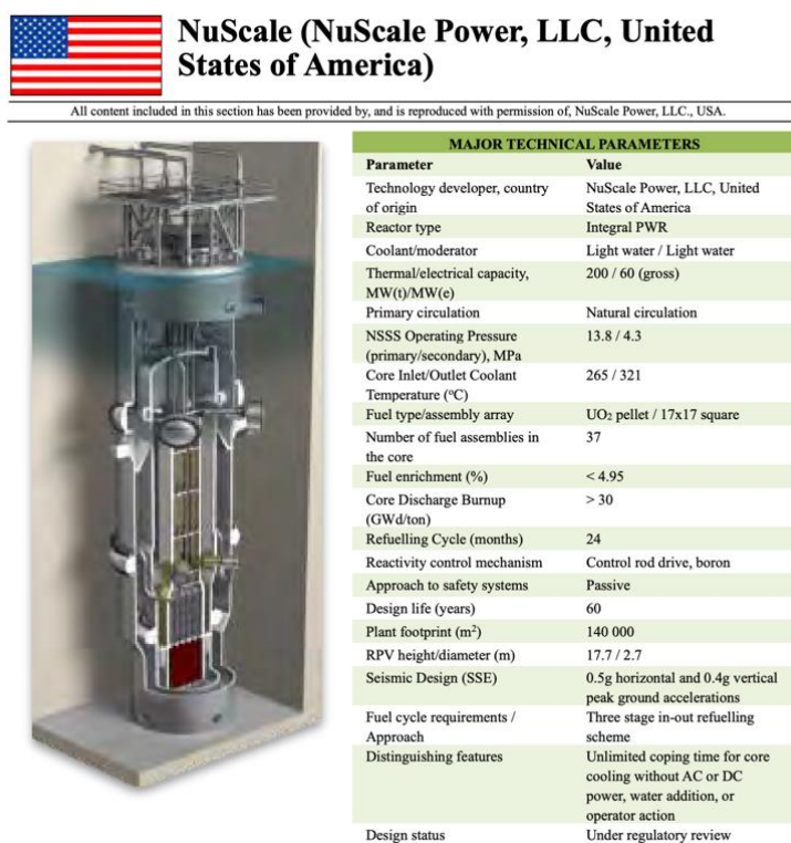
Рисунок 1 – Компоновка реакторного модуля NuScale (integral PWR) [1]
