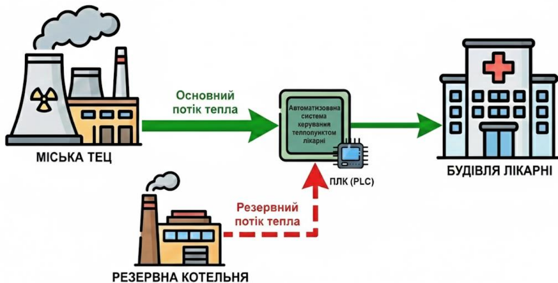
Рисунок 1 – Концептуальна схема керування тепловими потоками лікарні
