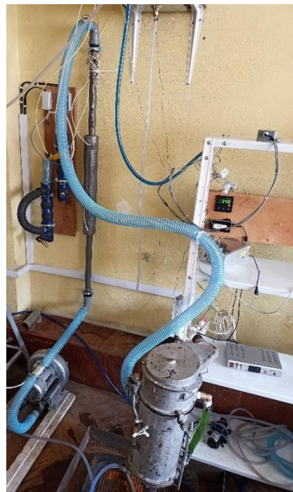
Рисунок 1 – Принципова схема контактної камери зволоження повітря ерліфтного типу (а) та її зовнішній вигляд на експериментальному стенді (б)
