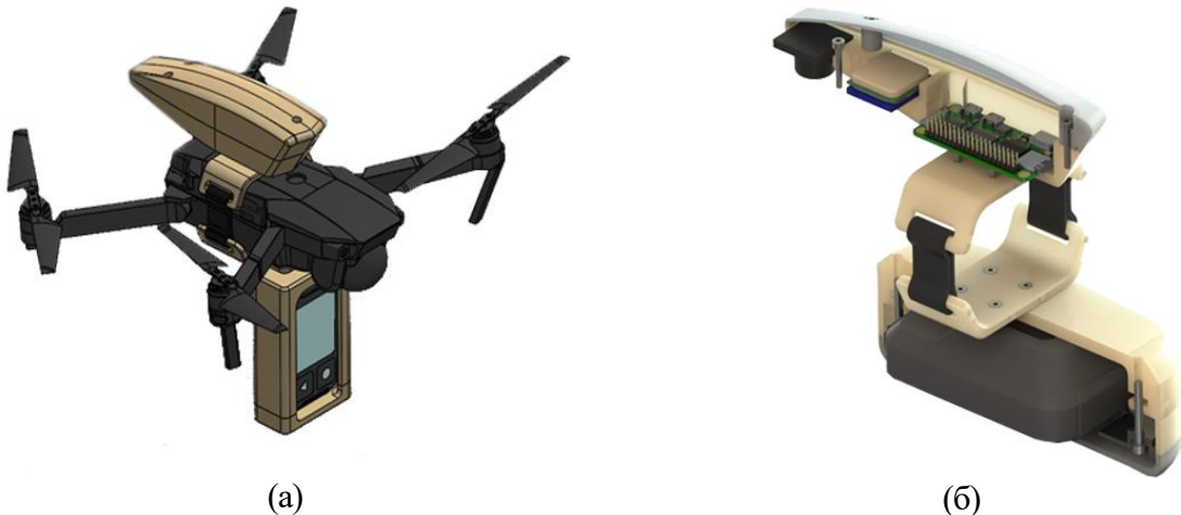
Рисунок 1 – 3D модель системи на базі дрону DJI Mavic 2 з детектором Mirion AccuRad PRD (а) та схематичне зображення корисного навантаження системи (б)
