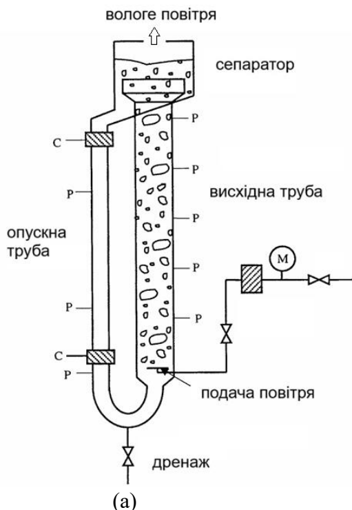
Рисунок 1 – Принципова схема контактної камери зволоження повітря ерліфтного типу (а) та її зовнішній вигляд на експериментальному стенді (б)
