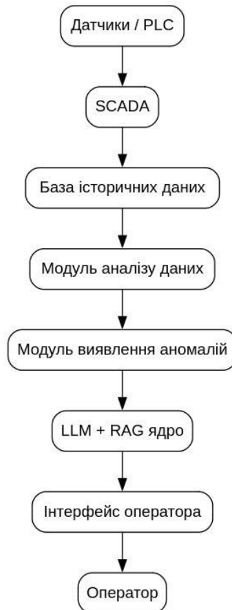
Рисунок 1 – Архітектура системи AI Operator Assistant
