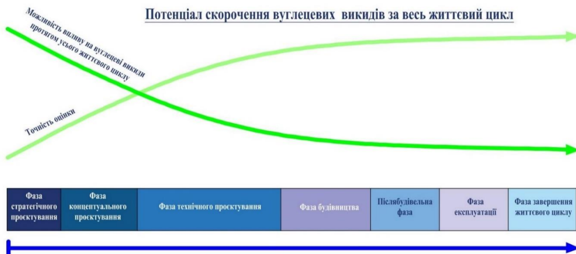
Рисунок 2 – Співвідношення експлуатаційних і приєднаних викидів протягом життєвого циклу енергетичної системи за EN 15978:2011 [3]
