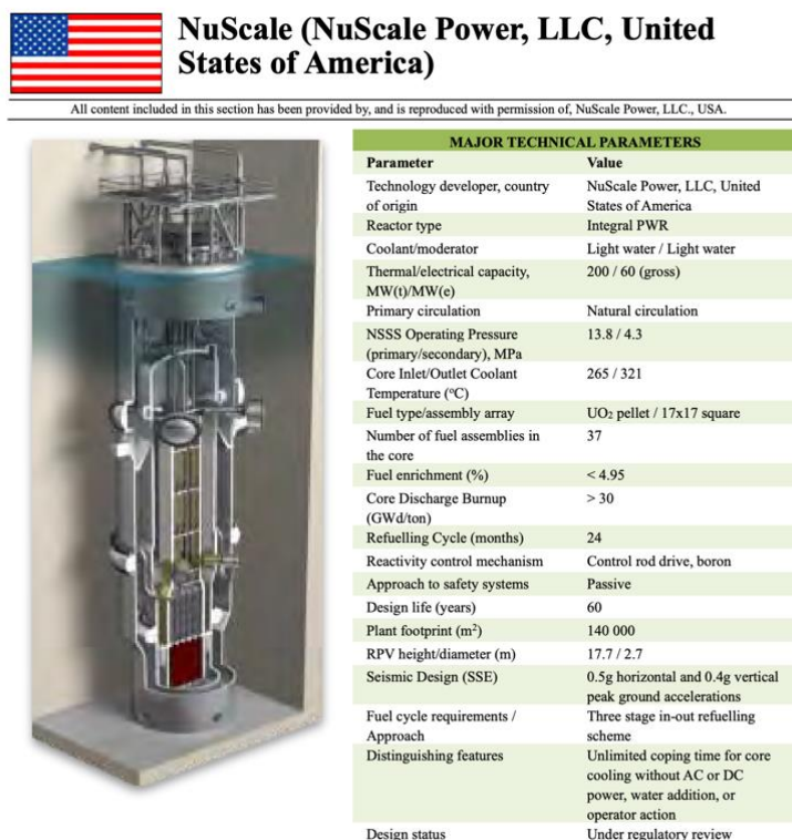
Рисунок 1 – Компоновка реакторного модуля NuScale (integral PWR) Джерело: IAEA, 2020
