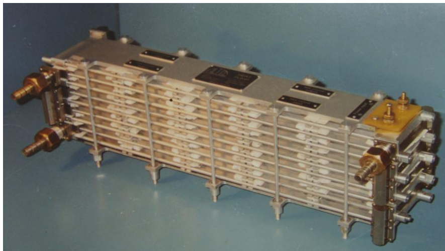
Рисунок 1 – Термоелектричний трансформатор тепла системи регенерації води пілотованого космічного апарату
