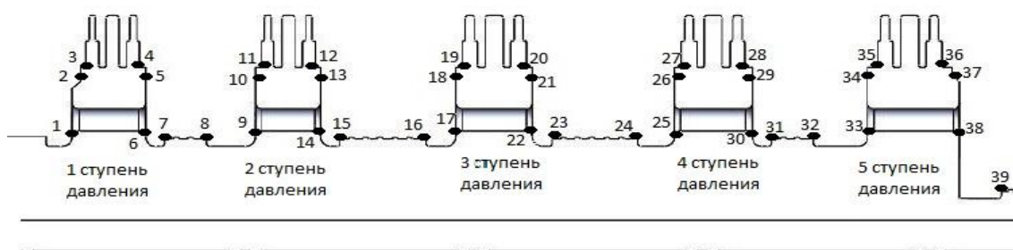
Рисунок 1 – Схема розташування точок для розрахунку коефіцієнтів тепловіддачі по поверхні ротора високого тиску парової турбіни К-1000-60/3000
