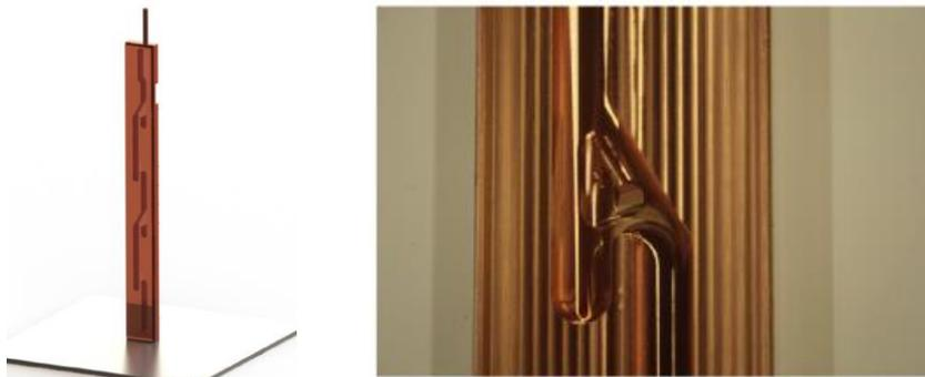
Рисунок 2 – Модель термосифону з проміжними басейнами та фото конструкції одного басейну [6]
