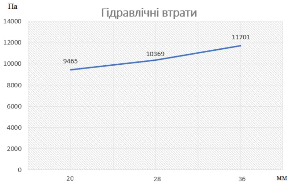
Рисунок 2 – Гідравлічні втрати в системі з колекторами круглого перерізу
