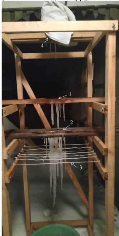
Рисунок 1 - Дослідна установка після 3 годин роботи. 1 - поверхня удару, 2 - дерев'яні насадки, 3 - дротяні насадки, 4 - ємність з водою
