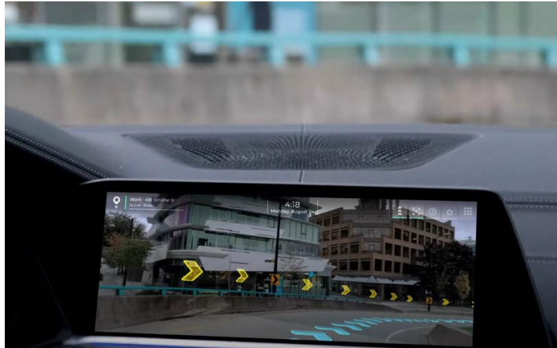
Рисунок 2 – Навігаційна система з використанням інструментів доповненої реальності
