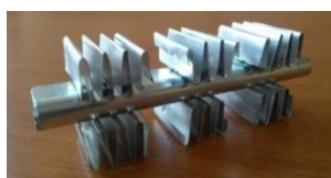
Рисунок 1 – Плоскоовальна труба з гофropодібним оребренням: зовнішній вигляд (а) та конструктивні параметри (б)
