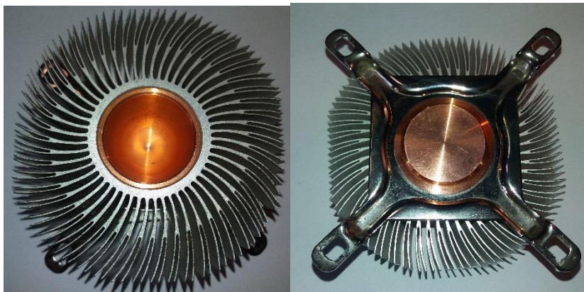
Рисунок 1 – система охолодження мікропроцесора на основі термосифона в розрізі (зліва) і вид знизу (справа)
