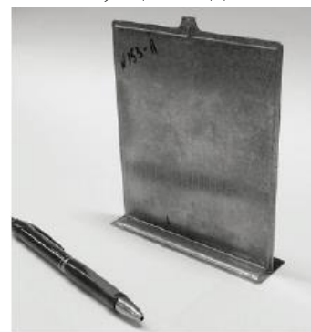
Рисунок 1 – Конструкція з вбудованою пласкою тепловою трубою
