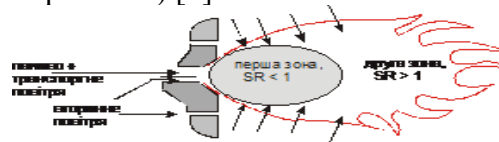
Рисунок 1 – Принцип стадійної подачі повітря
