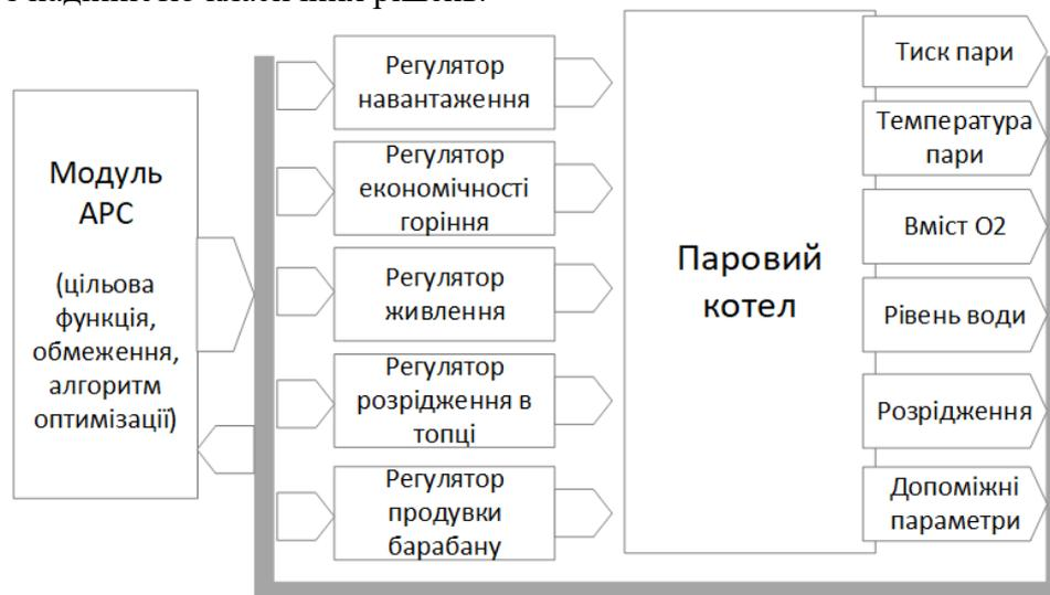
Рисуюнок 1 - Структурна схема керування паровим котлом
