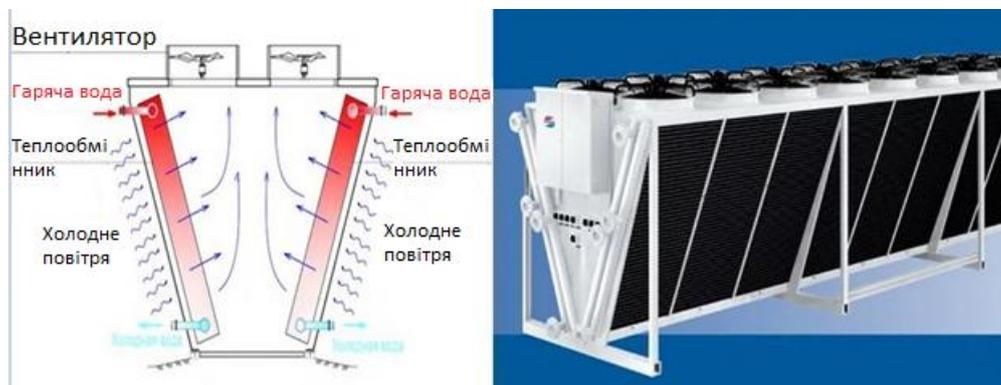
Рисунок 1 - Зовнішній вигляд та принцип роботи сухої градирні [2]
