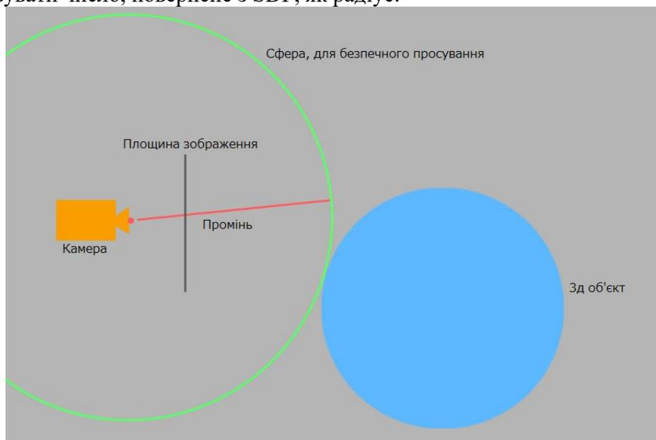
Рисунок 1 — Схема роботи просування променів
