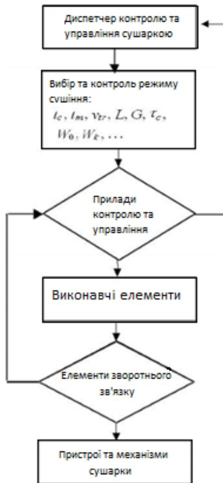
Рисунок 1 - Блок-схема системи управління сушаркою
