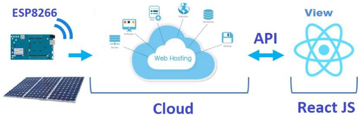
Рисунок 1 - Структурна схема хмарного рішення
