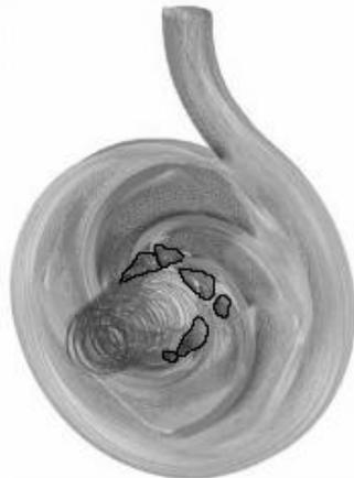
Рисунок 1 - CFD-модель, на якій продемонстровані кавітаційні бульбашки.
