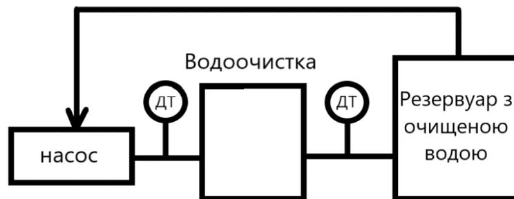
Рисунок 1 - Схема одноконтурного регулювання рівня рідини
