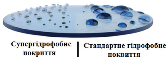
Рисунок 1 - Краплинна конденсація на супергідрофобній та гідрофобній поверхні.
