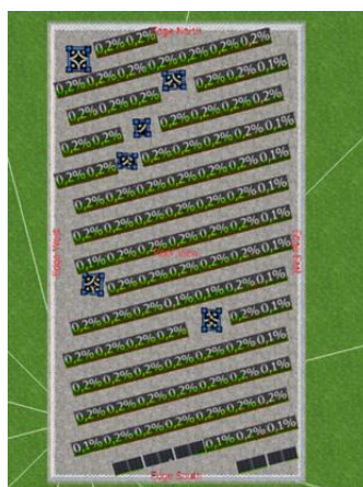
Рисунок 1 - Розміщення фотоелектричних панелей на даху будівлі при відстані між рядами модулів 1 м з врахуванням затінення і вентиляційних елементів даху будівлі
